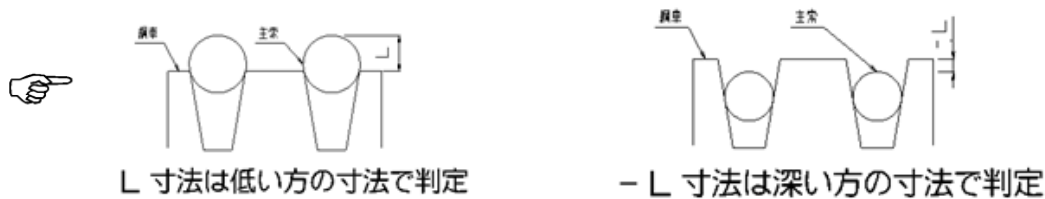
図 4-1-1 綱車ロープ溝とロープとの関係図
