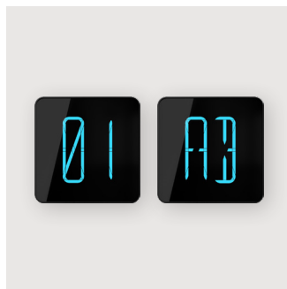
Leuchtanzeige der Etage und Fahrtrichtung
