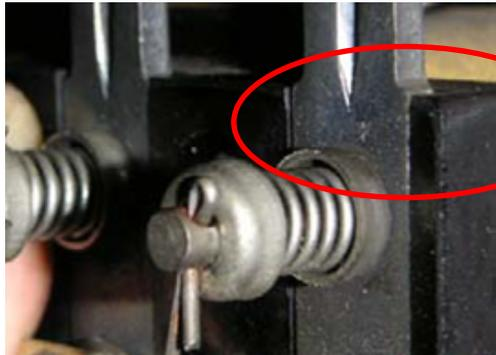
接触器の可動側を指でゆっくり ON させ、接点がベースの面まで可動することを確認する。
