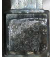
接点が摩耗している状態
